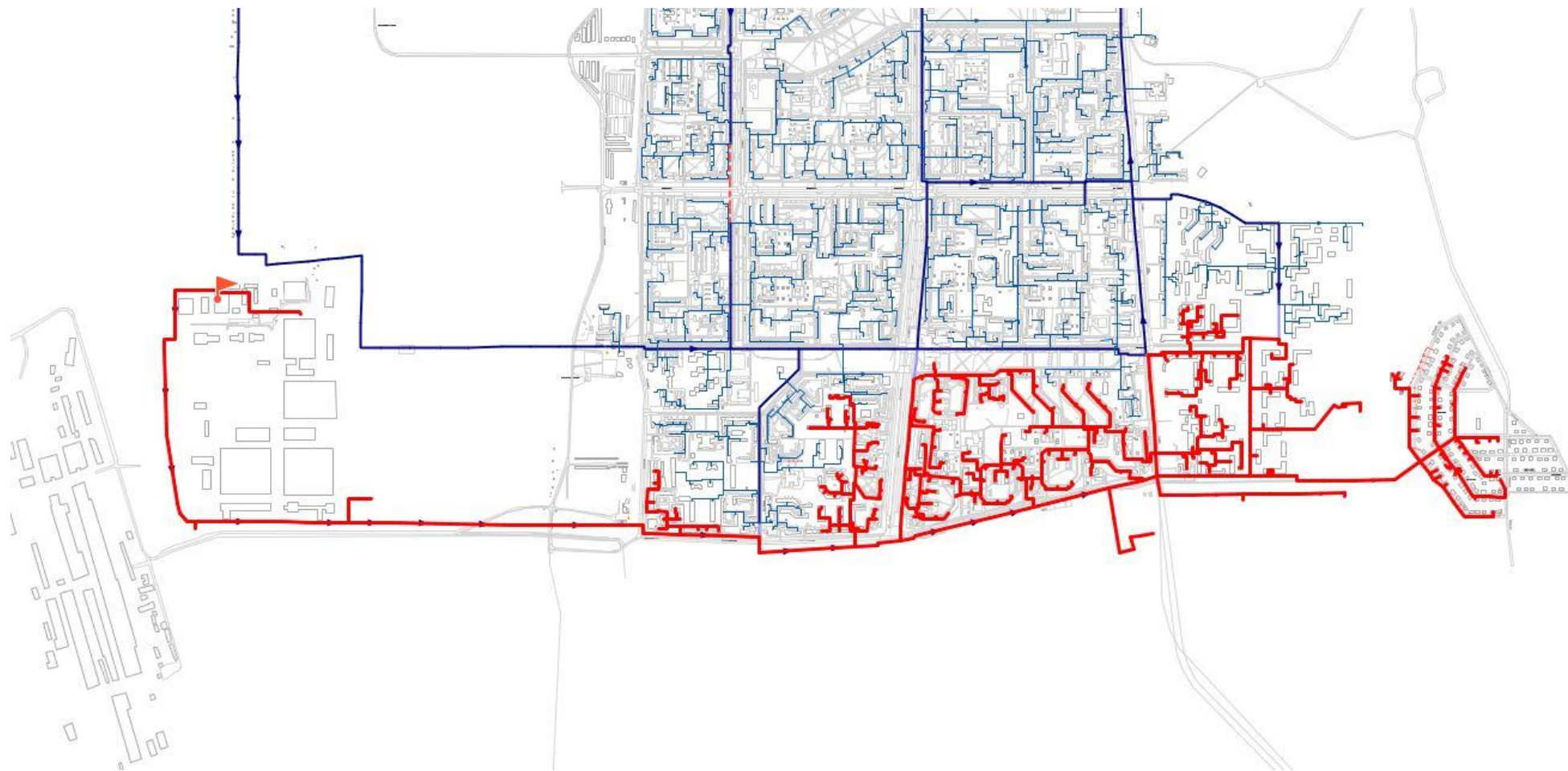
Рисунок 5.8 – Зона отключения при моделировании аварийного гидравлического режима
